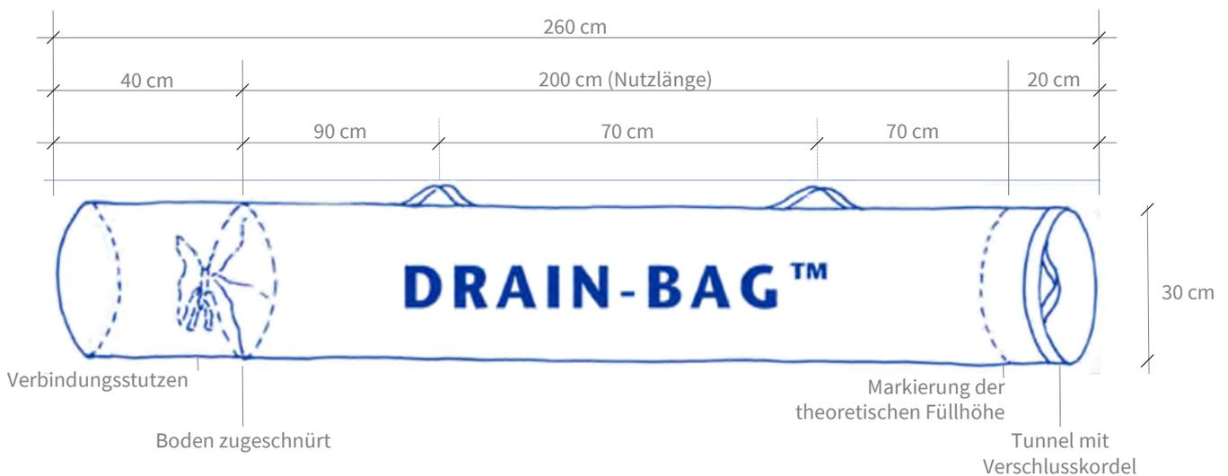
Der Drain-Bag wird werkseitig mit **MISAPOR DYNAMIC 10/50** abgefüllt. Das Füllmaterial ist resistent gegen Abrieb und hält grossem Druck stand.
