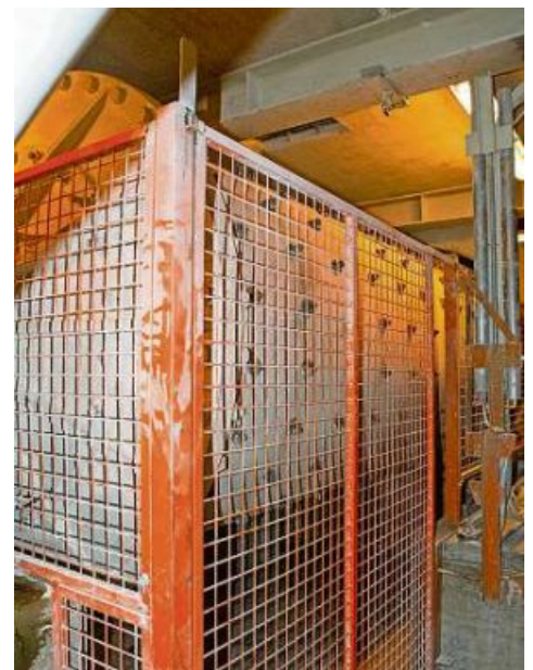
Vom Glas zum Mehl: die Trommelmühle.
