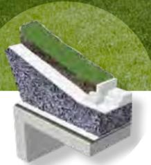
Als Leichtschüttung und Drainageschicht eignet sich MISAPOR für die Gestaltung von Stadtgärten, Dachbegrünungen sowie Spielplätzen. MISAPOR verkrallt bei der Verdichtung und rollt nicht, wodurch Modellierungen bis zu 45 Grad ohne seitliche Abstützung ermöglicht werden. Werden 1 m<sup>3</sup> herkömmliches Aufschüttmaterial durch 1 m<sup>3</sup> MISAPOR ersetzt, dann besteht ein Einsparpotenzial von 1,8 Tonnen Gewicht.
