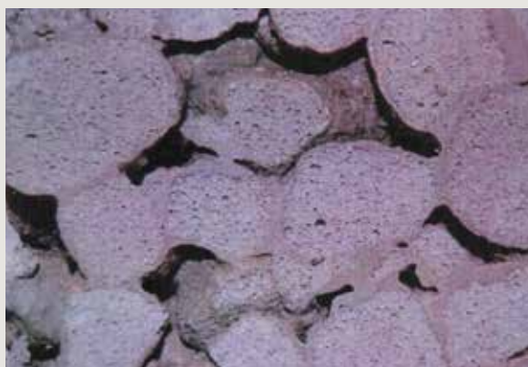
Structure de MISAPOR 10/50 lié au ciment en coupe transversale
