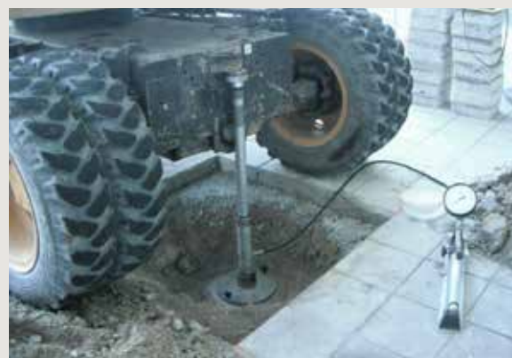
Essais à la plaque sur MISAPOR 10/50 lié au ciment, épaisseur de pose = 20 cm
