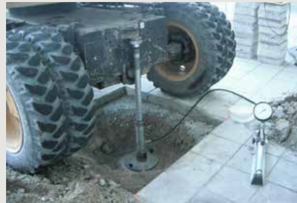
Lastplattenversuche auf MISAPOR 10/50 zementgebunden, Einbaudicke = 20 cm
